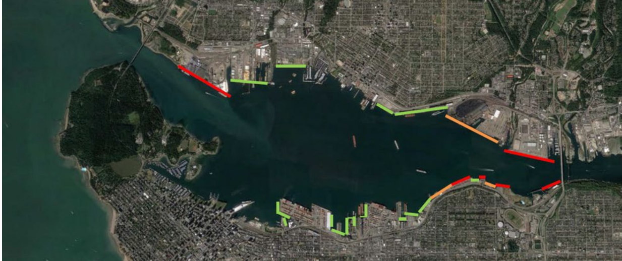
Figure 4 : Zones de courant de marée pour la planification (rouge = rapide, orange = modéré, vert = lent)
